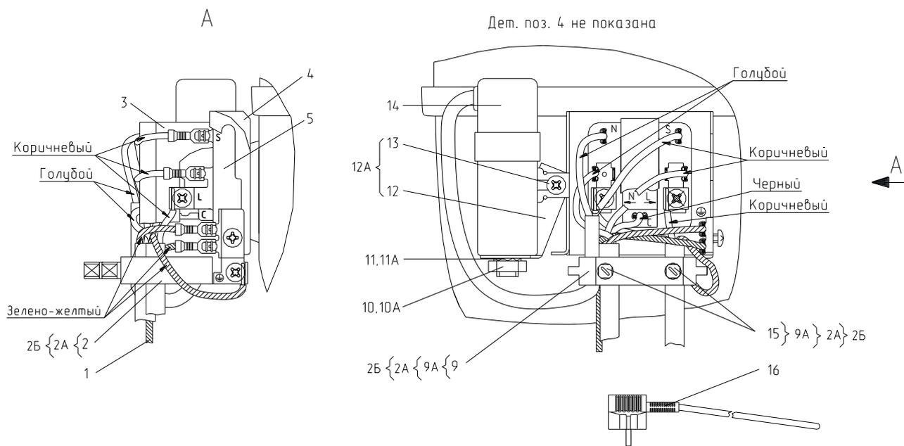
Рисунок 12 - Комплект пусковой (применяется с компрессорами типов TLY)
