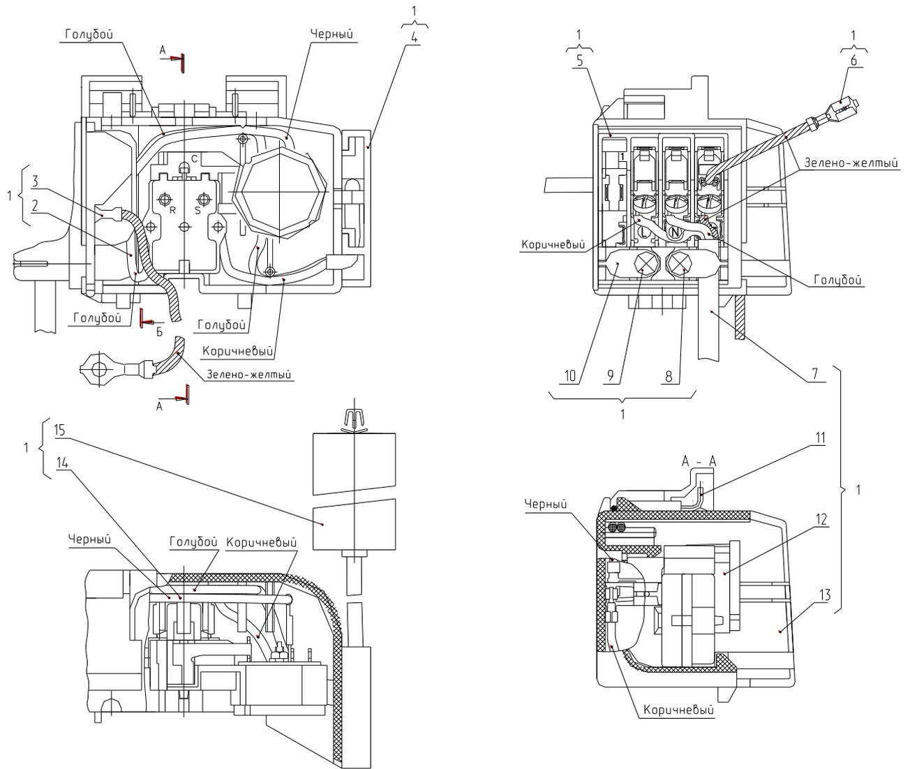
Рисунок 7 - Шнур питания (применяется с компрессором типа СТВ)
