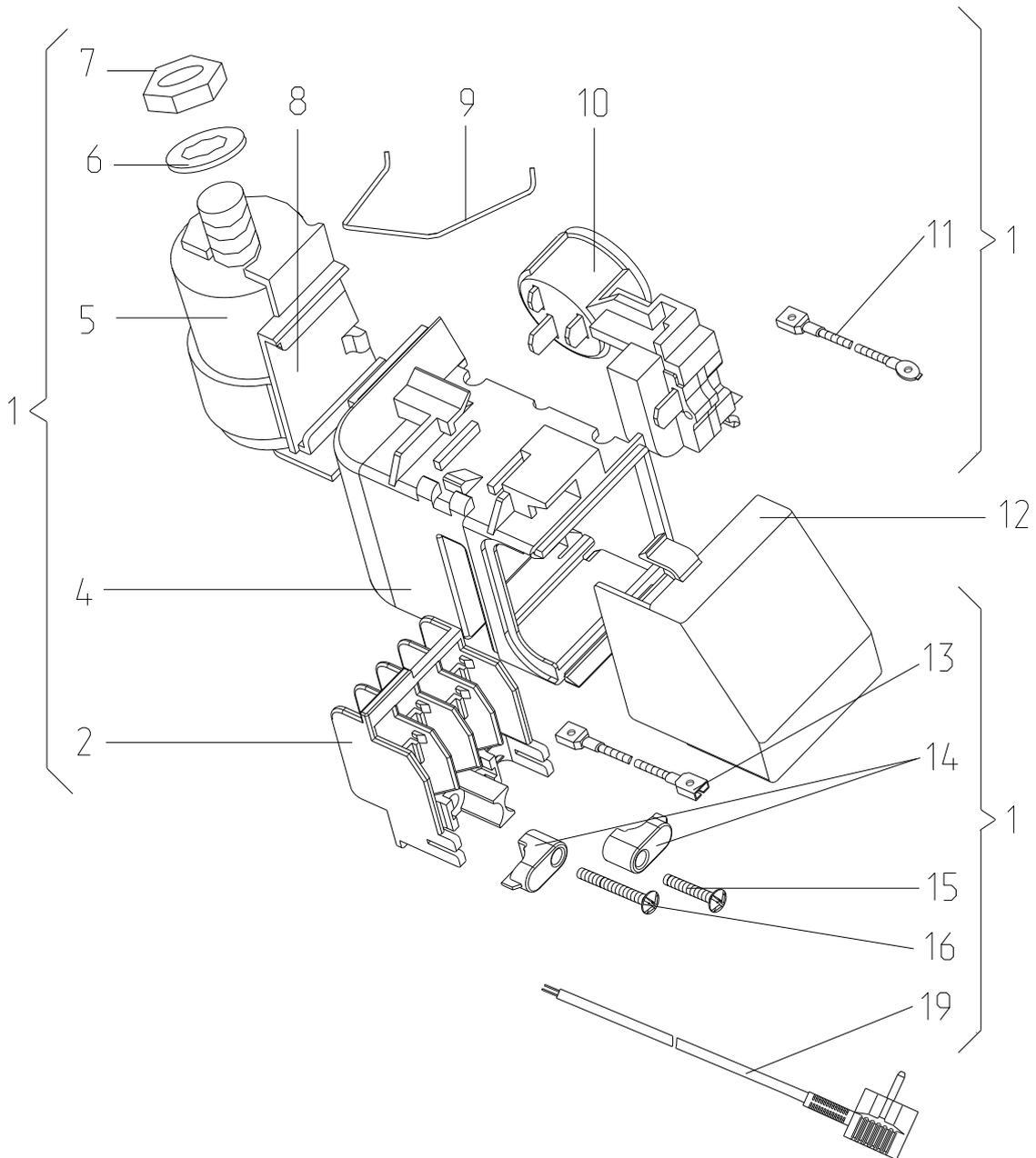
Рисунок 11 - Шнур питания (применяется с компрессором типа С-КН)
