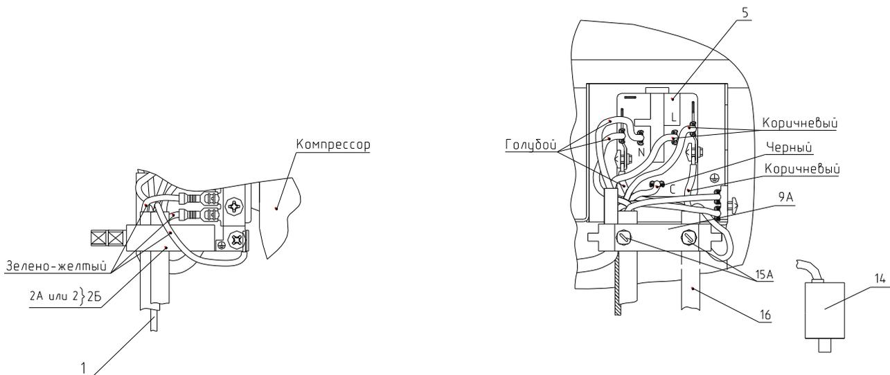
Рисунок 8 - Комплект пусковой (применяется с компрессором типа СТС)
