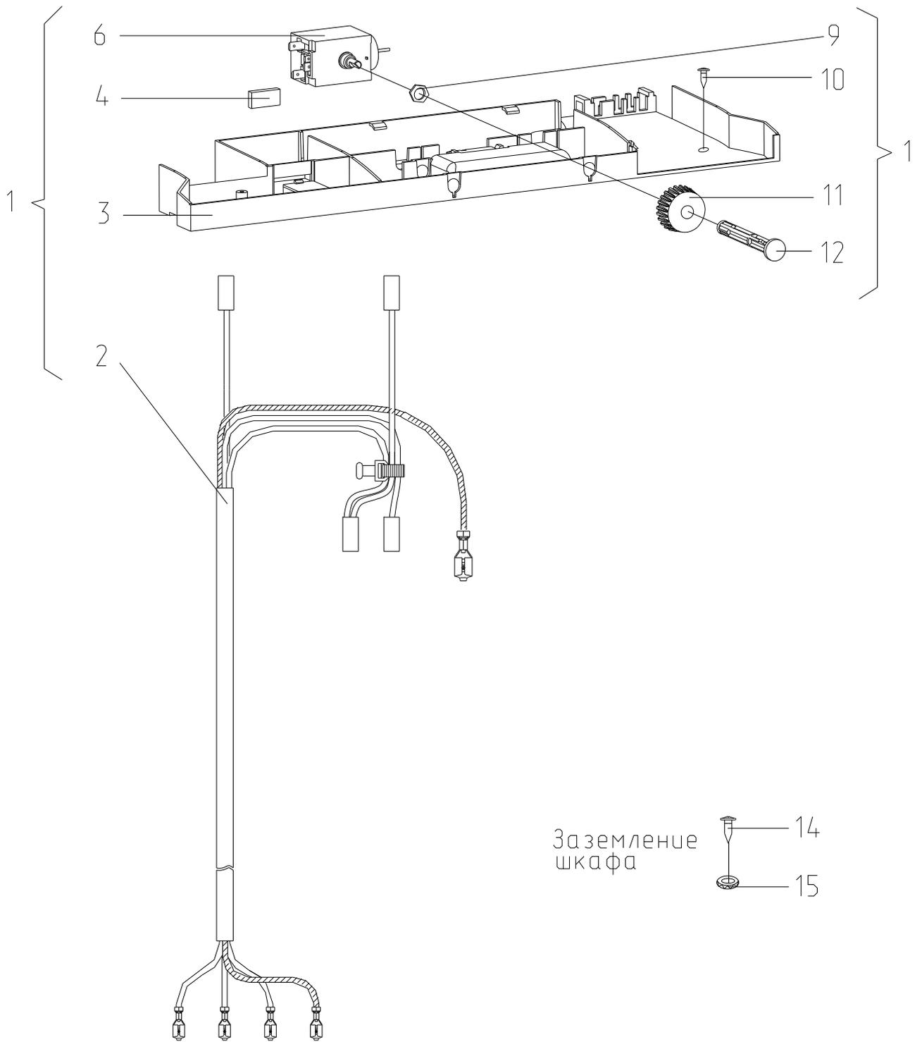
Рисунок 6 - Электропроводка
